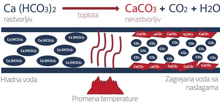
**Energy Water MWD je uređaj koji omekšava vodu koristeći princip galvanizacije – rešenje za sprečavanje nastanka vodenog kamenca.**
